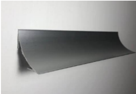
Curva sanitaria en aluminio, altura 5 cm y largos de 6.10 ml, curva aparente, se instala con adhesivo acrilastic
